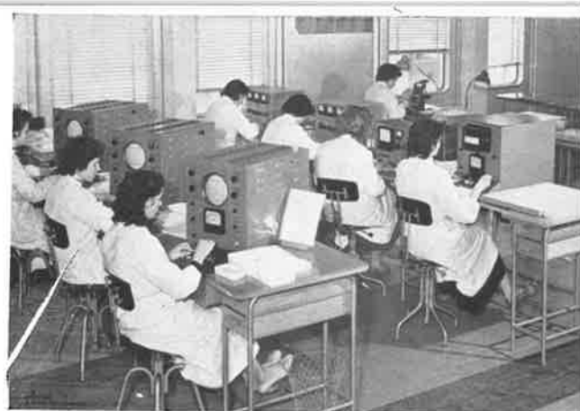
Les bancs d'essai pour transistors se trouvent dans une vaste salle climatisée.
